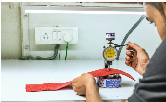
Thickness Gauge (0-10 mm & LC 0.01 mm)
